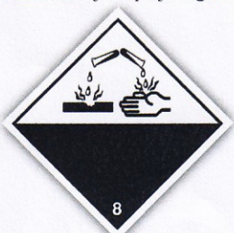
Broj 8 Korozivne (nagrizajuće) materije
